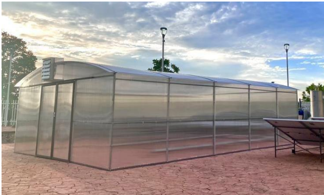
Figura 13 Secador solar tipo invernadero para filete de pescado, instalado en la Facultad de ingeniería UAC.
