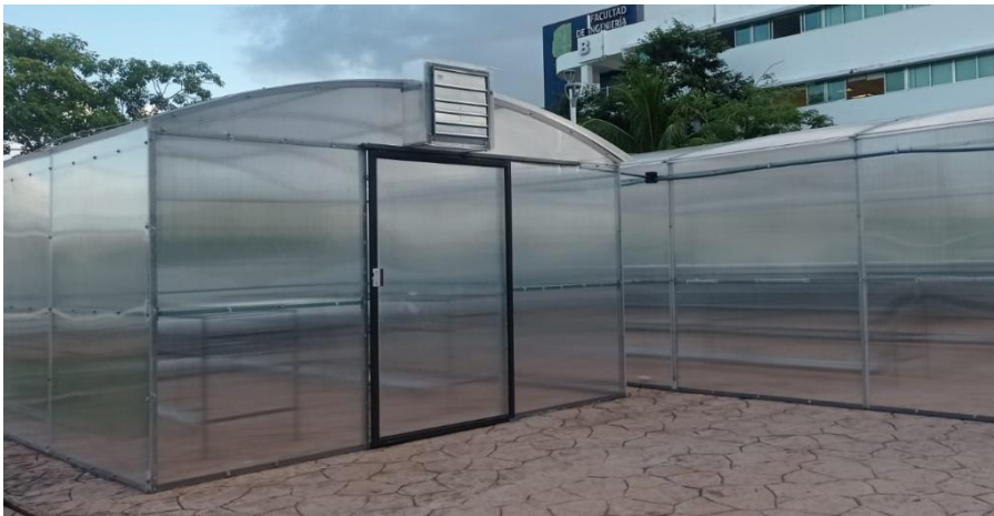
Figura 15 Secador solar tipo invernadero para residuos de pescado del laboratorio de secado solar, Facultad de Ingeniería UAC
